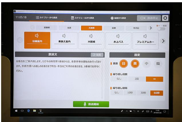
タブレットの多言語放送サービスの操作画面。誰でも簡単に操作できるインターフェースで、設置駅に合わせて用意された放送文章を選択して信頼性の高い多言語放送が可能。
