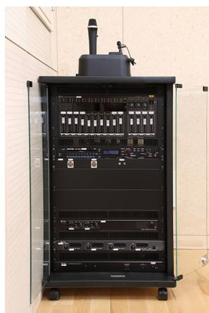
音楽室にあるワゴンアンプ。CD / メモリープレーヤーやデジタルステレオミキサーなどが収められている。上にあるのは、ハンド型とタイピン型のデジタルワイヤレスマイクロホン。
