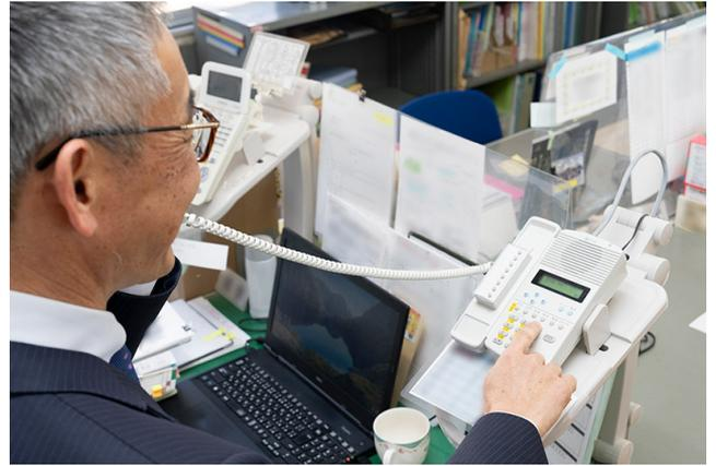
職員室にはI P多機能端末N-8600MSが2台設置されている。液晶付きのため、連絡元の教室が視覚的に分かるようになっている。
