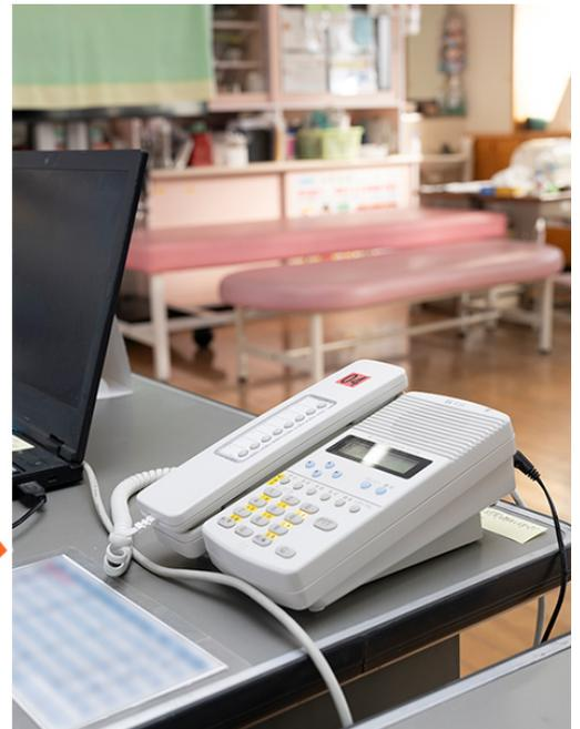
保健室には通話履歴の確認ができる液晶付きのI P多機能端末N-8600MSが設置されている。通常の電話と違ってLANケーブルが引き延ばせるので、設置場所を変えられて連絡も受けやすくなったとのこと。
