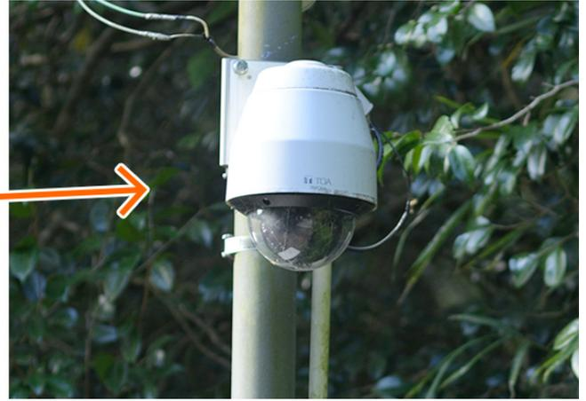
馬場橋より上流にある「平川（古城）」に設置されたTRIFORAカメラN-C5700。カメラは光回線でネットワークに接続されており、町役場でカメラ映像を確認。
