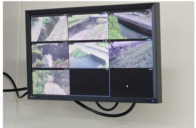
総務部防災交通課の執務室に設置されたモニターで、町内7カ所にある河川監視カメラの映像を常を確認できる。
