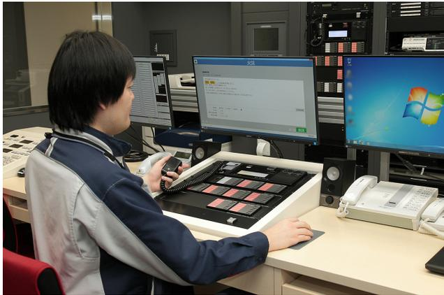
マウス操作で放送したい文面を選択。変更箇所や繰り返し放送する回数を設定するだけで、合成音声による多言語の自動放送が可能です。放送する人の発音や声質に左右されず、いつ放送しても聞き取りやすい音質で、多言語放送を実現しています。
