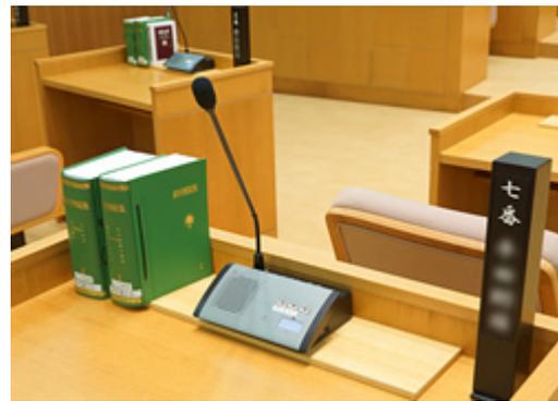
議員席用の参加者ユニットTS-912。電子採決が採用されており、「賛成」・「反対」ボタンを押すと、採決結果が本会議場の大型モニターや議長席の7型モニター、操作席のタッチパネルモニターに表示される。
