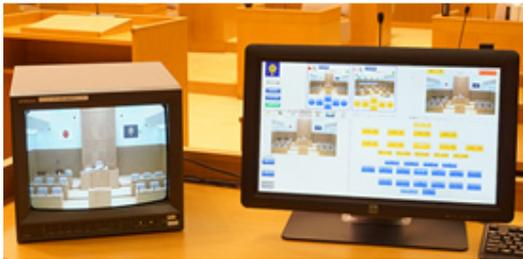
操作席のタッチパネルモニター。会議システム、カメラシステム、発言残時間システム、テロップ、電子採決システムの制御が行える。また、議会だよりに掲載する写真もスナップショット機能で、操作席から撮影できる。
