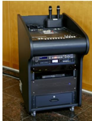
後方の松、竹の間にそれぞれ設置されているサブ卓。上部にはイベント内容に応じて音響調整を行えるデジタルステレオミキサーM-864Dが、下部にはデジタルワイヤレスチューナー、デジタルパワーアンプなどが収納されている。
