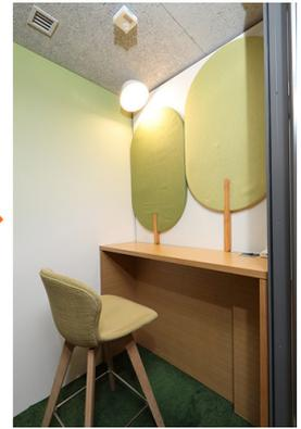
各フォンブースにはあらかじめテーマ（写真はwoods）が設定されている。長時間の利用でもストレスを感じにくい空間を実現するため、空間に溶け込む吸音パネルを採用。テーマにあわせた自然音（鳥のさえずり、小川のせせらぎ）をもとにしたマスキングにより、フォンブース間の会話や音漏れを低減。
