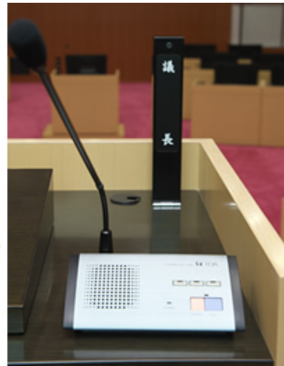
議長席に設置されている赤外線会議システムの議長ユニットTS-901。指向性の高いマイクとの組み合わせでハウリングも抑制。
