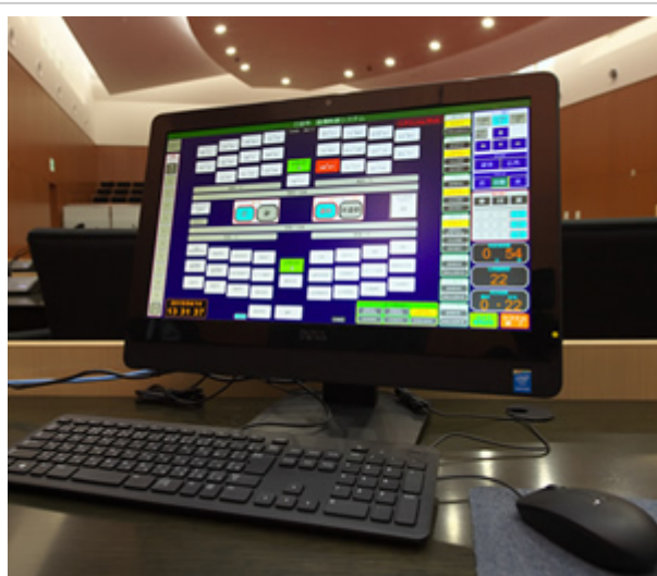
議会事務局席にある赤外線会議システムの議会運営ソフトウェアが入った操作用PC。システム全般の集中制御を行うほか、カメラの制御やテロップ表示などが可能。
