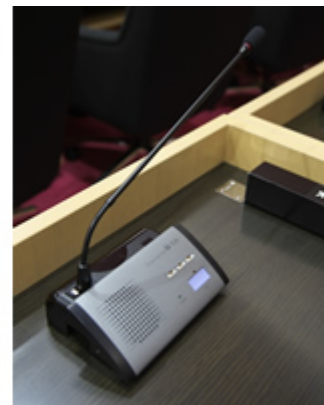
執行部席の赤外線会議システムの参加者ユニットTS-902。すべての席に、着席発言、立席発言に対応したロングマイクが設置されている。
