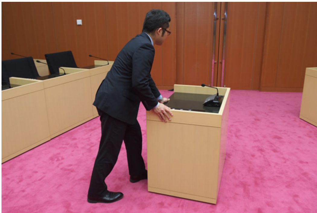
議席が可動式のため、コードレスで設置できる赤外線マイクユニットを採用。レイアウト変更や多目的利用の際の席の移動が容易。
