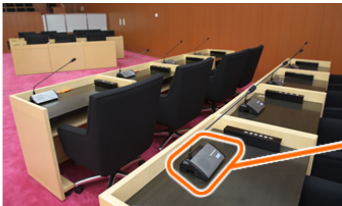
執行部席の赤外線会議システムの参加者ユニットTS-902。すべての席に、着席発言、立席発言に対応したロングマイクが設置されている。
