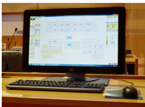
操作席にある議会運営ソフトウェアが搭載されたPCのモニター画面。マウス操作で、マイクのON / OFFや録音、発言残時間や出席議員数のモニターへの表示などが簡単に行える。
