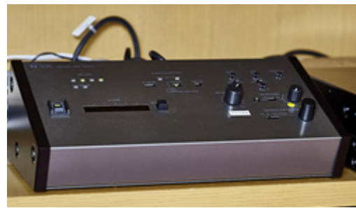
棚の上段にある有線赤外線統合会議システム センター装置TS-910。
