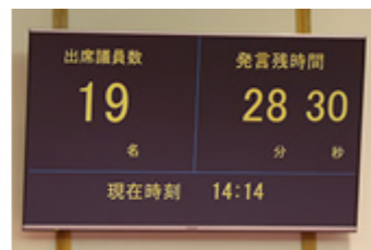
本会議場の左右の側面に設置されている50型のモニター。マイクと連動して発言者の映像や本会議場全体の映像、出席議員者数と発言残時間などを表示できる。
