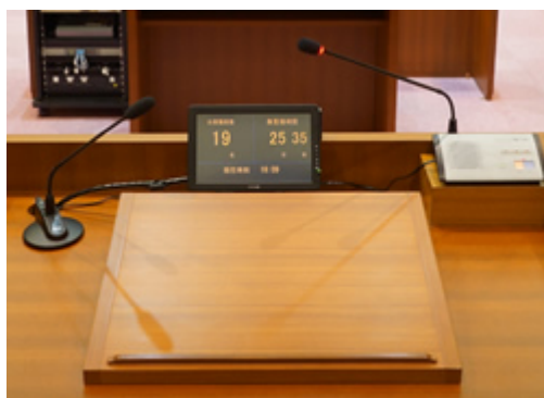
議長席に設置されている議長ユニットTS-901, 7型のモニターには、出席議員数・残時間・カメラ映像を切り替えて表示できる。また議会運営ソフトウェアとは独立した有線式コンデンサーマイクも設置。
