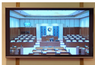
本会議場の左右の側面に設置されている50型のモニター。マイクと連動して発言者の映像や本会議場全体の映像、出席議員者数と発言残時間などを表示できる。
